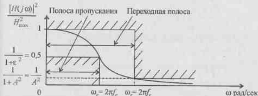
Рис. 6.6. Пример расположения особых точек при расчете ФНЧ Баттерворта
