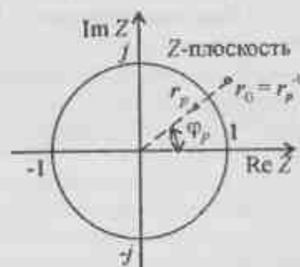
Рис. 9.1. Пример расположения полюса и нуля ВЦКЯ первого порядка
