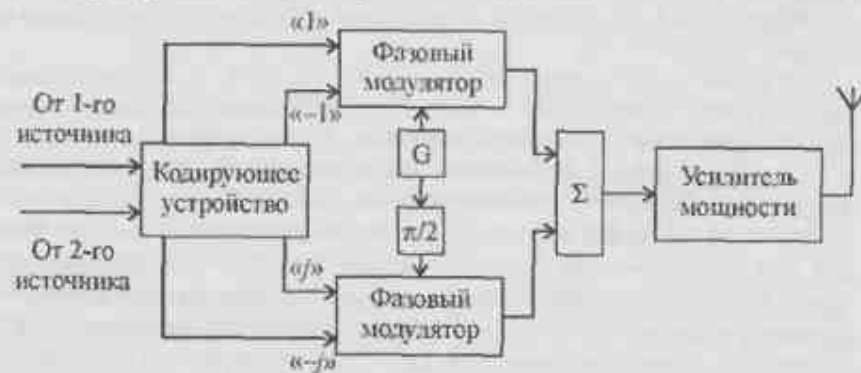
Рис. 17.3. Структурная схема модулятора
