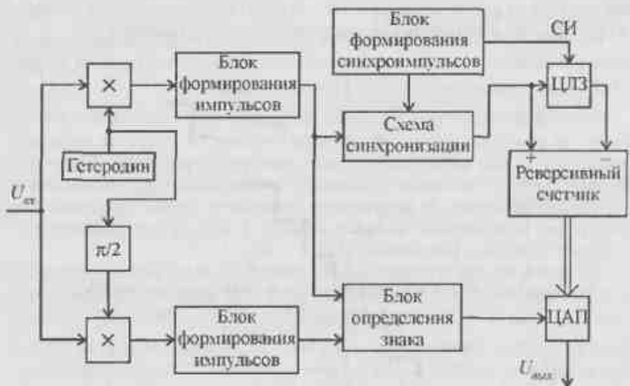
Рис. 13.16. Структурная схема ЦЧД с непрерывным съемом информации (режим работы «скользящее» окно)
