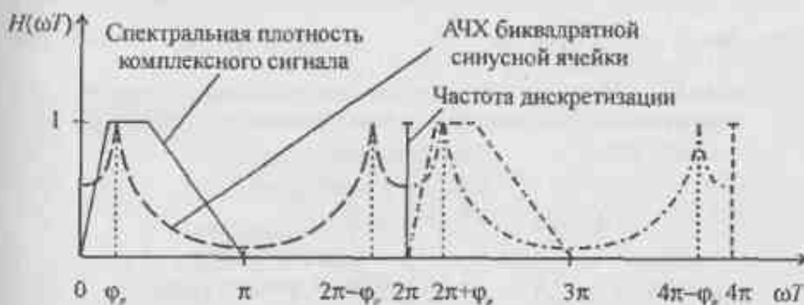
Рис. 4.33. Пример расположения дискретизированного спектра комплексного (аналитического) сигнала и АЧХ биквадратной синусной ячейки
