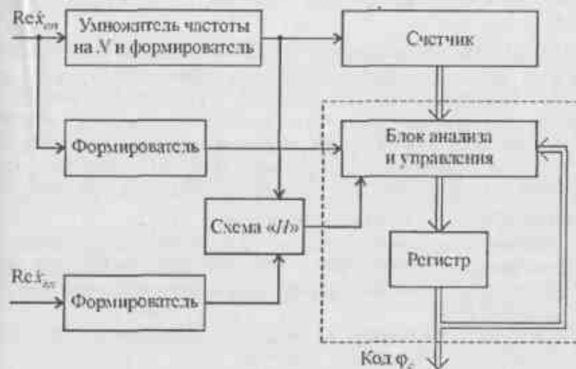
Рис. 13.2. Структурная схема цифрового фазометра с марковской последовательностью циклических отсчетов
