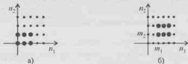
Рис. 15.7. Пример сдвига двумерной последовательности: а) без сдвига; б) со сдвигом
