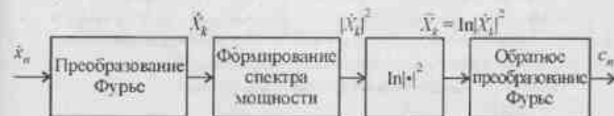
Рис. 12.6. Структурная схема системы вычисления кепстра
