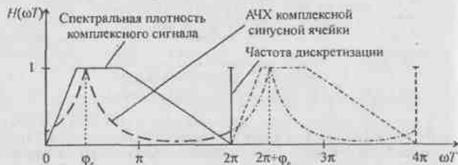
Рис. 4.32. Пример расположения дискретизированного спектра комплексного (аналитического) сигнала и АЧХ цифровой комплексной синусной ячейки
