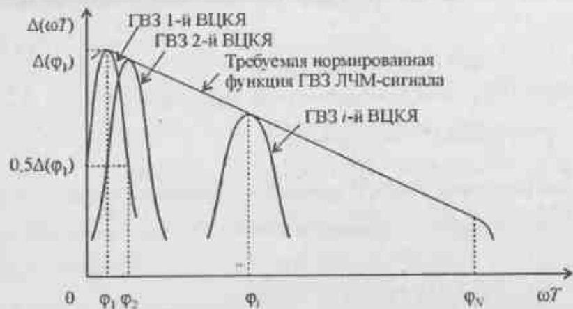
Рис. 9.3. Пример разбиения на подинтервалы нормированной функции ГВЗ согласованного ВЦМФ для ЛЧМ-сигнала
