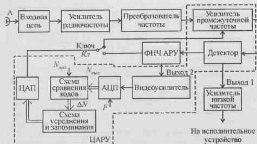
Рис. 14.1. Структурная схема РПрУ с ЦАРУ и аналоговой АРУ
