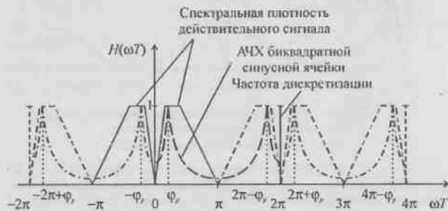
Рис. 4.35. Пример расположения дискретизированного спектра действительного сигнала и АЧХ биквадратной синусной ячейки
