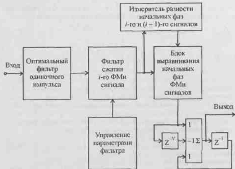
Рис. 16.2. Структурная схема устройства, реализующего обработку ансамбля фазоманипулированных сигналов
