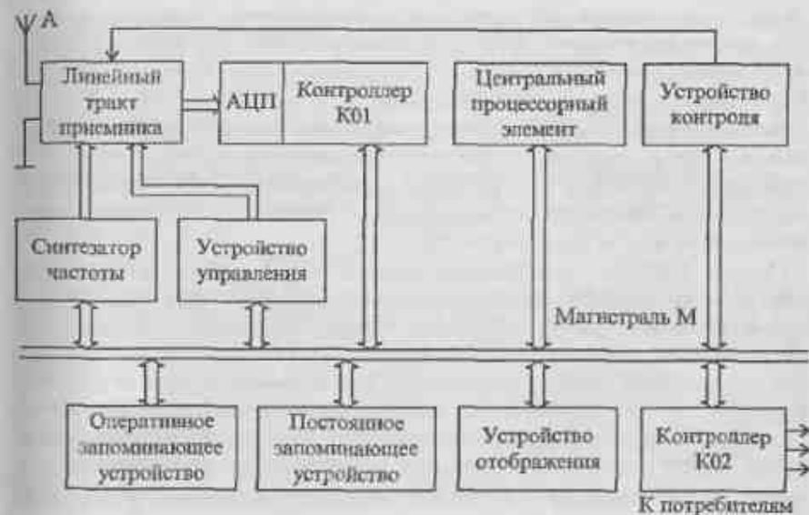
Рис. 1.2. Структурная схема цифрового процессора с программной реализацией
