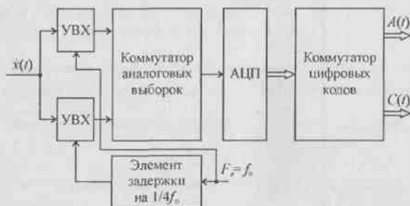
Рис. 2.6. Структурная схема формирователя квадратур с использованием близости форм узкополосного и гармонического колебаний
