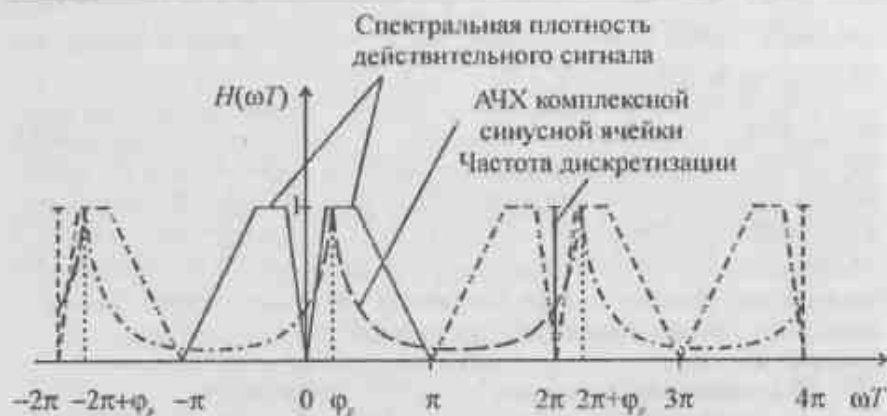
Рис. 4.34. Пример расположения дискретизированного спектра действительного сигнала и АЧХ комплексной синусной ячейки
