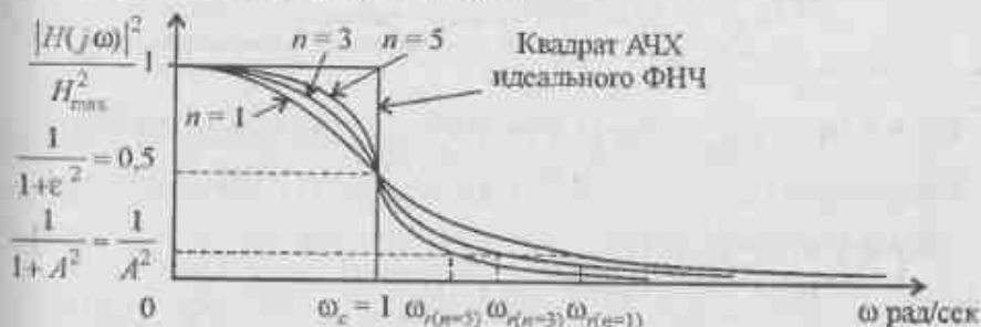
Рис. 6.4. Примеры АЧХ ФНЧ Баттерворта различных порядков
