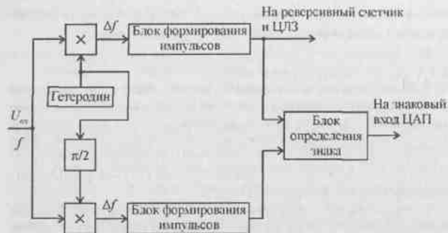
Рис. 13.15. Структурная схема блока определения знака расстройки \Delta f
