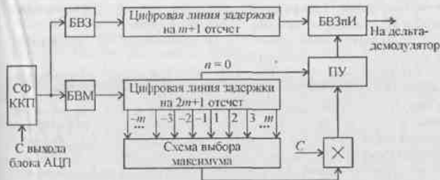
Рис. 18.14. Структурная схема робастного порогового устройства
