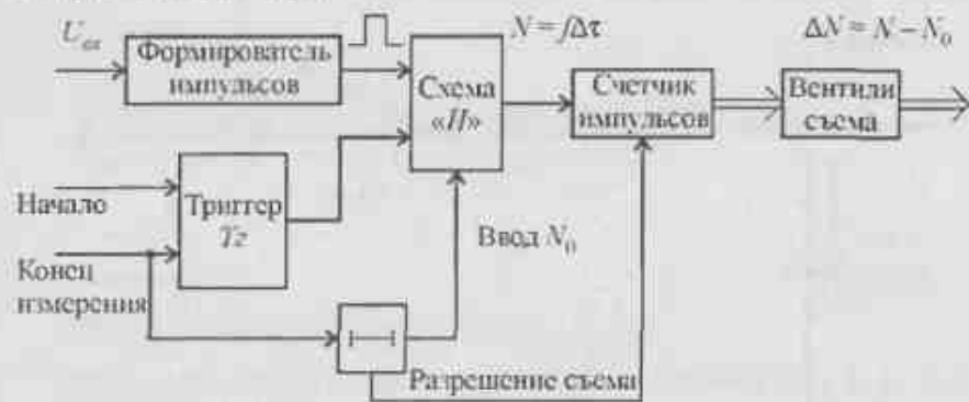
Рис. 13.12. Структурная схема ЦЧД для режима работы «скачущее» окно
