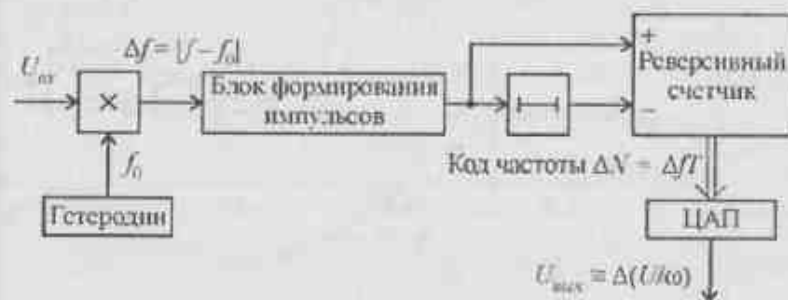
Рис. 13.13. Структурная схема ЦЧД с непрерывным съемом информации
