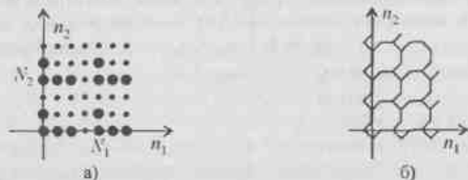
Рис. 15.6. Примеры двумерных периодических последовательностей: а) в виде «уголка»; б) в виде «ракеты»
