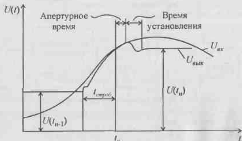
Рис. 2.14. Пример временных диаграмм напряжений на входе и выходе УВХ
