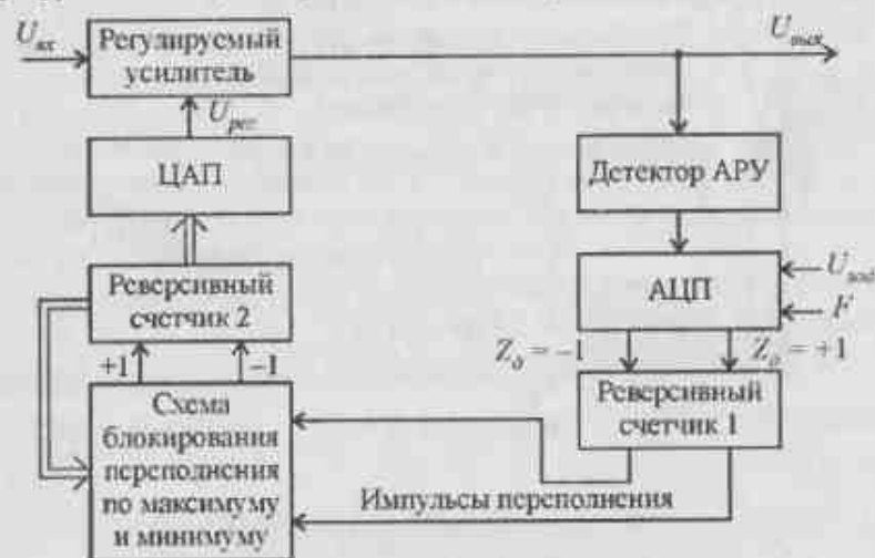
Рис. 14.3. Структурная схема ЦАРУ с бинарным квантованием аналогового сигнала
