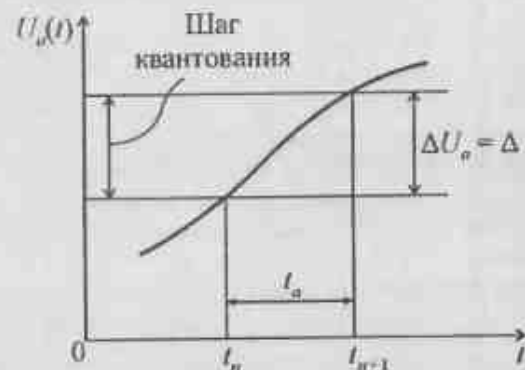
Рис. 2.10. Связь апертурной погрешности t_a с шагом квантования \Delta U_n = \Delta
