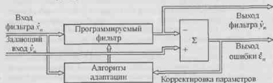
Рис. 8.1. Структурная схема адаптивной системы
