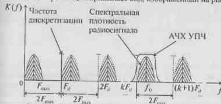
Рис. 2.3. Виды спектральной плотности сигнала при выборе частоты дискретизации F_d \geq 2F_{\max}
