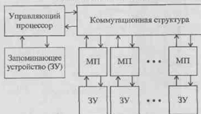
Рис. 1.5. Иерархическая архитектура многопроцессорной вычислительной системы
